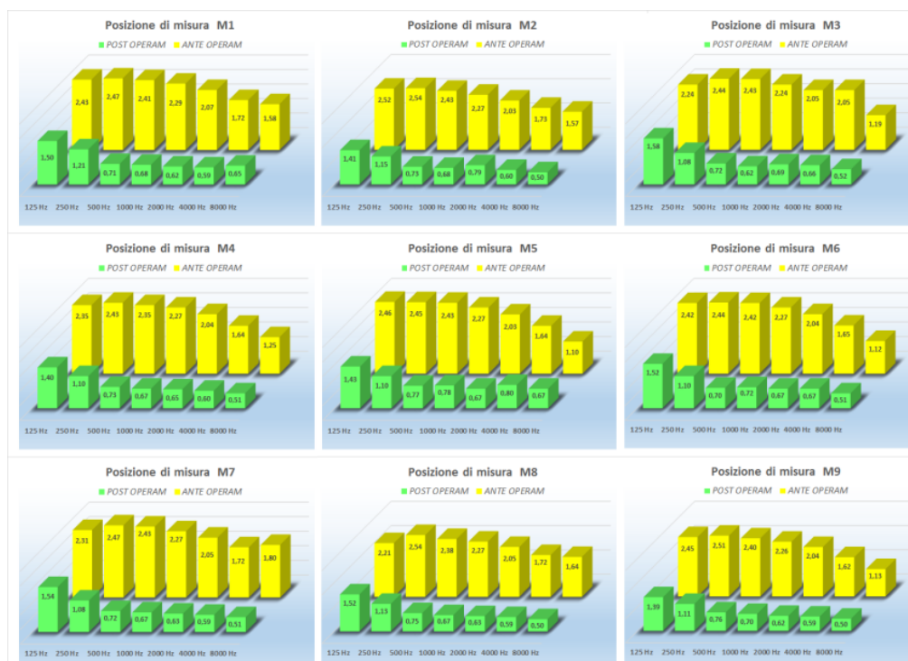
Fig. 24 Confronto tra i tempi di riverbero misurati alle varie frequenze prima e dopo la correzione acustica
